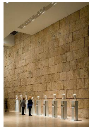
سكك غاطسة في السقف بحيث يمكن تحريك أجهزة السبوت لايت على مسار السكة أو إزالتها ونقلها من سكة لسكة أخرى
