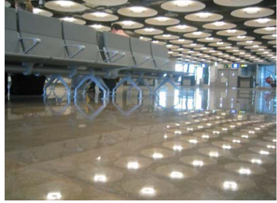
الإنارة المباشرة بوجود أرضية لامعة تسبب وهج منكس يؤدي إلى إنخفاض أداء الرؤية ويكون مزعج للمكان
