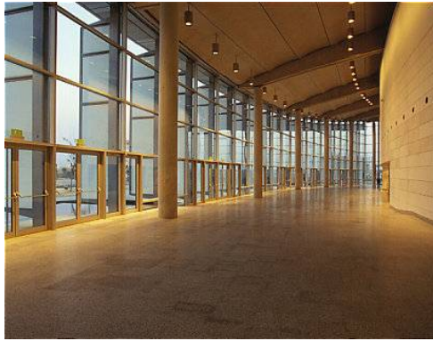
تجانس قليل للإنارة في هذا الممر
