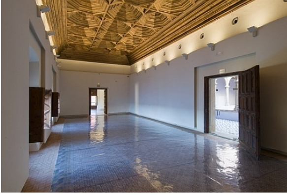
الإنارة الغير مباشرة تكون مناسبة للأرضية اللامعة وتحسن مجال الرؤية بإنعدام الوهج المنعكس.
