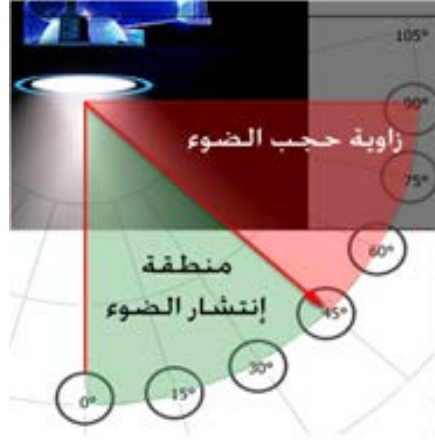
الشكل التالي يبين منطقة حجب الضوء ومنطقة إنتشار الضوء
