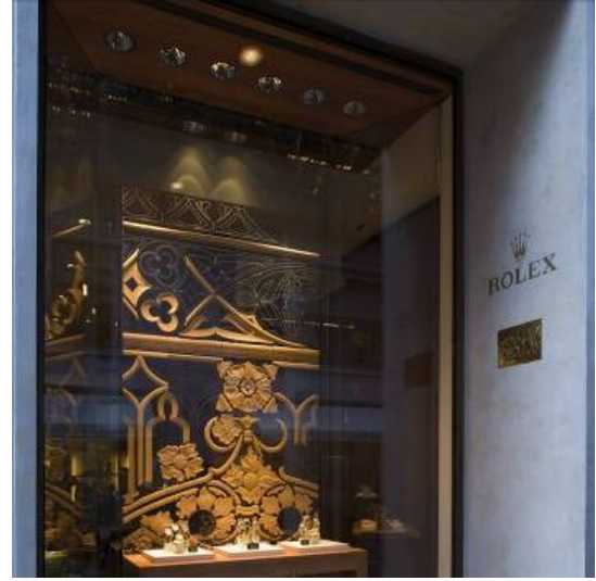
أجهزة إتجاهيه غاطسة في السقف للإنارة المركزة
