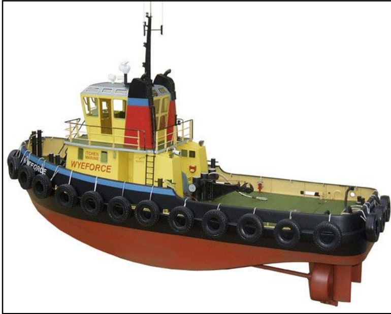
شكل (١٦ - ١) قاطرة تقليدية ثنائية الرفاص
