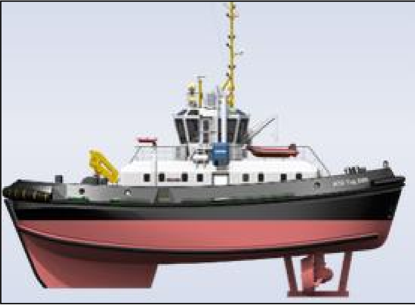
شكل (١٨-١) قاطرة جرار ذات رفاصات السميت
