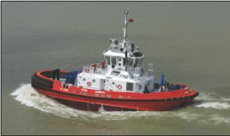
شكل (٤-١) قاطرة ميناء ذات رفاص (Z-drive)
