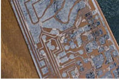
لاحظ انه في بعض الأحيان تكون هناك بعض الأجزاء الصغيرة التي لم تلتصق بالتونر لعدم وصول الحرارة إليها بشكل كافي فقم بترقيعها بقلم ذو حبر مقاوم للحمض ( قلم دوكو ) قبل عملية الغمس في الحمض , ثم اغمسها في الحمض
