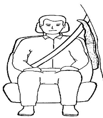
شكل (١٣) يوضح مراحل انتفاخ كيس الهواء الجانبي
