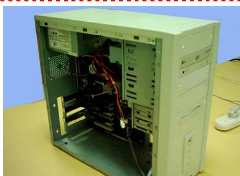
إـذـاـ مـاـ شـمـمـتـ رـائـحةـ اـحـتـرـاقـ يـجـبـ إـغـلـاقـ الـجـهـازـ فـورـاـ وـلـاـ تـزـعـجـ وـلـكـنـ بـهـدـوـءـ قـمـ بـفـحـصـ الـجـهـازـ مـرـةـ آخـرىـ بـمـسـاعـدـةـ مـدـرـيـكـ فـقـدـ يـكـونـ هـنـاكـ أـيـ تـمـاسـ بـسـيـطـ أوـ أـسـلاـكـ مـتـصـلـةـ بـطـرـيقـ الـخـطـأـ .ـ بـعـدـ تـصـحـيـحـ الـخـطـأـ جـرـبـ مـرـةـ آخـرىـ بـمـسـاعـدـةـ مـدـرـيـكـ .ـ
