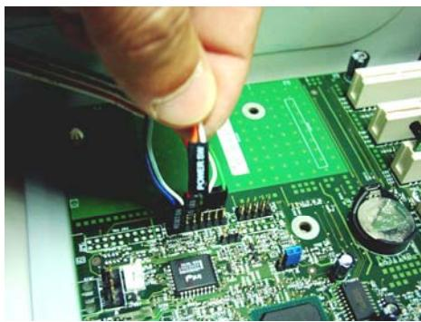
بعد ذلك يتم تركيب الأـسـلاـكـ الخـاصـةـ بمـفـتـاحـ الطـاقـةـ وـمـؤـشـرـ .ـ مـلـبةـ .ـ الـقـدـرةـ وـمـؤـشـرـ .ـ مـلـبةـ .ـ الـقـرـصـ الصـلـبـ وـمـفـتـاحـ إـعـادـةـ التـشـغـيلـ وـ السـمـاعـاتـ الدـاخـلـيـةـ عـلـىـ اللـوـحـةـ الـأـمـ .ـ كـمـاـ يـجـبـ مـلـاحـظـةـ وـيـجـبـ الـاستـعـانـةـ بـالـدـلـلـيـلـ المـرـفـقـ مـعـ الـلـوـحـةـ الـأـمـ ،ـ كـمـاـ يـجـبـ مـلـاحـظـةـ أـنـ هـذـهـ الـأـسـلاـكـ تـكـوـنـ مـوـجـودـةـ فـيـ الـجـهـةـ الـأـمـامـيـةـ لـعـلـةـ النـظـامـ
