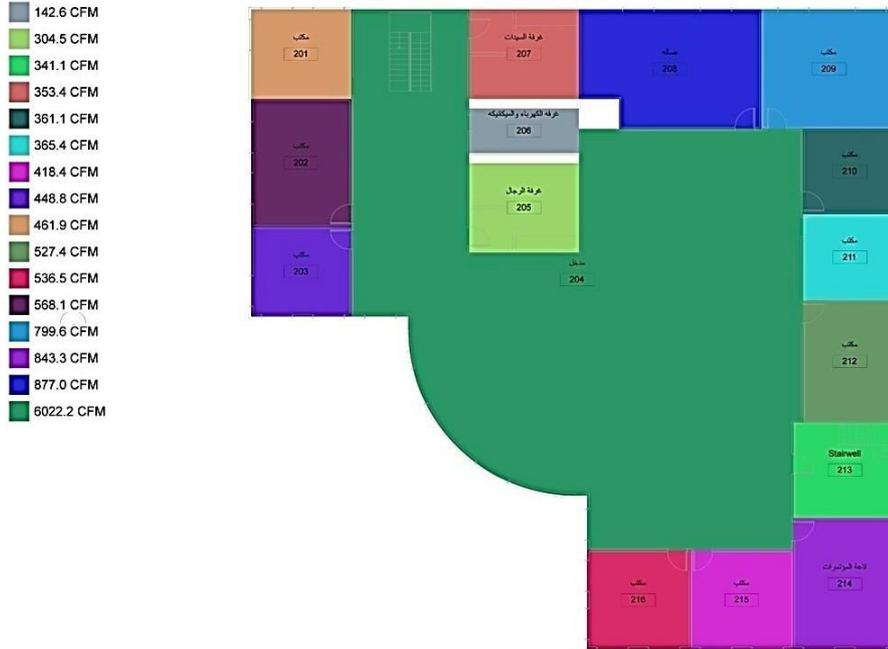
الشكل (4.14) تقرير بمعدلات انسياب الهواء لغرف المبنى للطابق الأول باستخدام الأداة
