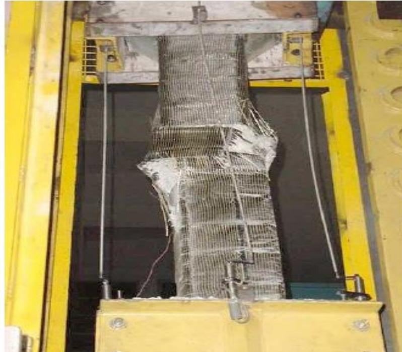
الشكل (13-2) : عمود مقوى بشرائح الـ CFRP - (C-F-2-00) , [ Mahmoud et al ,2004 ]
